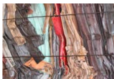
PVC selezionato e pressato
