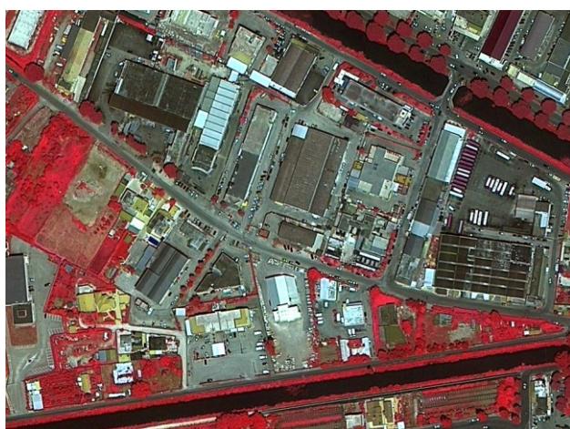
Sopra: Analisi di dati multispettrali nel visibile e nell'infrarosso per l'identificazione di superfici contenenti amianto (evidenziate in blu). Sotto: ortofoto (RGB+NIR della stessa area) per la visualizzazione della tipologia di edifici presenti nell'area.
